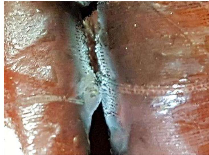
**Descargas Parciales de Tipo Corona, debidas a la presencia localizada de un campo eléctrico intenso.**
