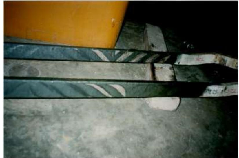
**Descargas Parciales Superficiales, debidas a la presencia de un componente del campo eléctrico, paralelo a la superficie del material aislante.**
